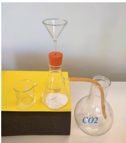
Εικόνα 1: Παρασκευή και διαβίβαση \text{CO}_2
